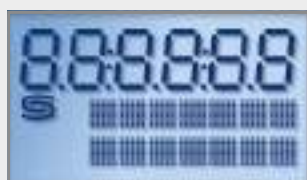
Программируемая индикация на дисплее xx-ECATP Typ 2
