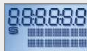
Программируемая индикация на дисплее xx-ECATP Typ 2
