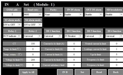
Parameter and Alarm Setting
