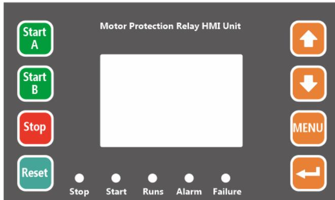
Energom-PR240 имеет HMI (Ч-М Интерфейс), подключаемый к реле кабелем DB9; Он используется для отображения параметров и их настройки, также можно использовать клавиши для управления работой или для остановки двигателя. Светодиодный индикатор показывает состояние двигателя.
