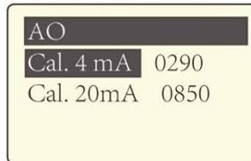
**Внимание:** Этот экран (режим) предназначен для калибровки, уже откалиброван на заводе. Пользователю не нужно проводить дополнительную калибровку снова.
