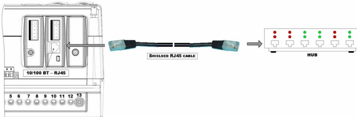
Рис.17 Подключение прибора через Ethernet
